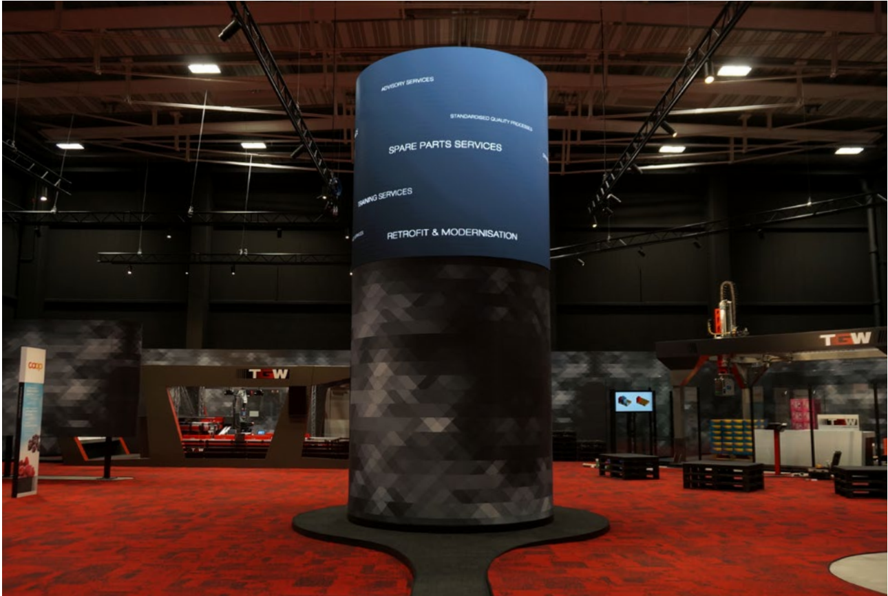
Größe: 6 x 2,5 m Durchmesser 2,6 m Pixelabstand 3,9 mm Auflösung 1.536 x 640 px
