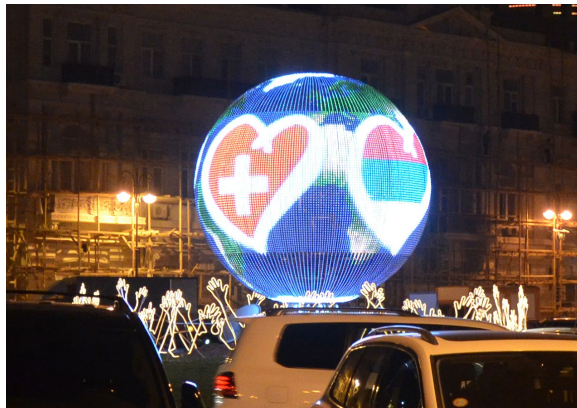
Durchmesser 5 m Pixelabstand 50 mm Auflösung 312 x 96 px
